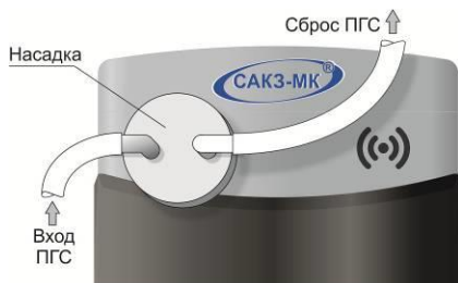
Рисунок Е.1 – Установка насадки для подачи ПГС
