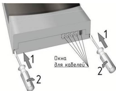
Рисунок 4 – Снятие крышки клеммного отсека
