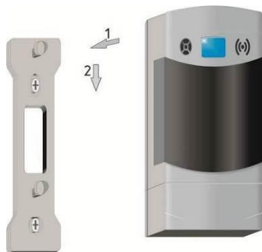
Рисунок 5 – Установка сигнализатора на монтажную панель
